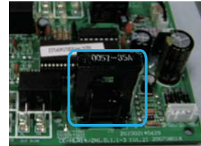
Защита компрессора по току
